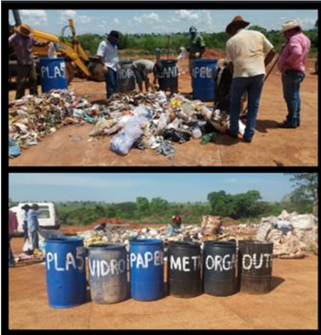
Figura 6- Processo de separação de acordo com as características dos resíduos.
