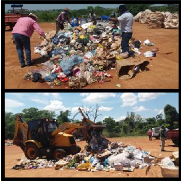
Figura 4 - Processo de homogeneização dos resíduos sólidos.
